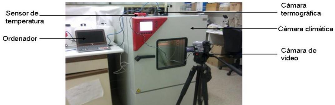
**Figura 7.** Equipamiento utilizado para la medida de los límites térmicos.
